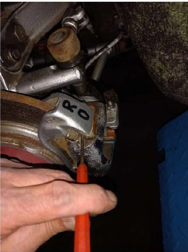
dann die Keile selbst. Dazu wird mittels geeigneten Dorns sowohl oben als auch unten jeweils der Keil vorsichtig herausgetrieben (nach innen). Die weitere Beschreibung spare ich mir hier, sie ist ausführlich in meiner Doku zur Überholung der Radbremszylinder beschrieben.
