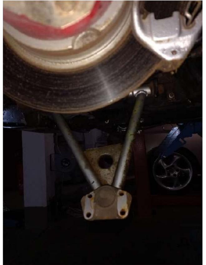
Nun wird die große Zentralmutter gelöst. Dies kann nur mit einem langen Hebel erfolgen, denn neben dem Anzugsdrehmoment blockieren auch die eingeschlagenen Sicherungen recht gut. Aber es geht, nur Beharrlichkeit! Die Mutter verbleibt zunächst auf den letzten Gewindegängen.
