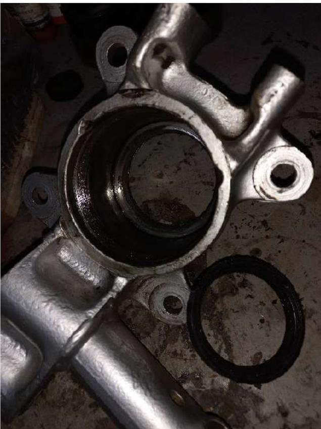
So sieht der Radnabenträger am Ende von innen aus, nach der Reinigung mit Lappen, Zahnbürste und Bremsenreiniger wird alles wieder leicht mit neuem Fett versehen.
