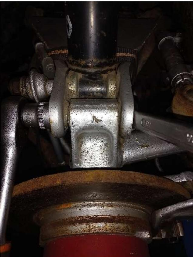
Bevor das Gelenk ganz gelöst wird, sollte man die Schraube am oberen Querlenker außen lösen und zum Teil herausdrehen, damit etwas Spiel in die Angelegenheit kommt.
