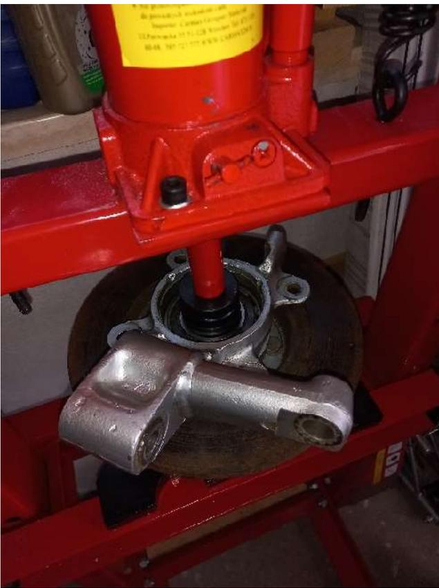
Mittels der hydraulischen Werkstattpresse, in meinem Fall 12 t, wird der Zapfen in das Lager eingepresst. Vorsichtig, nicht verkanten!
