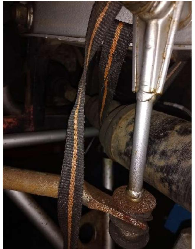
Damit die Antriebswelle nicht herabhängt oder aus dem Differential rutscht, wird sie abgefangen.
