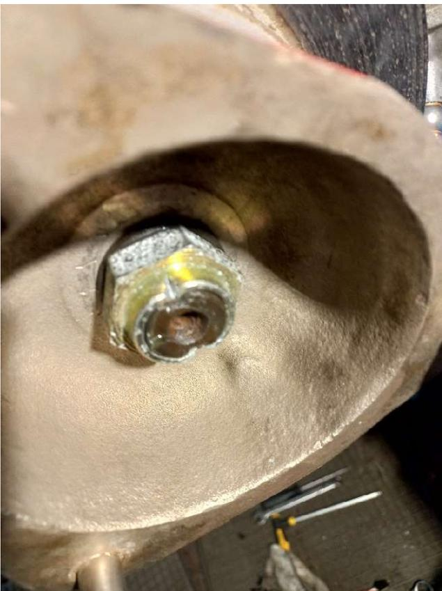
Zweitens: Nicht vergessen, am Ende die (neue!) Zentralmutter auf der Antriebswelle mit 250 Nm anzuziehen und am Rand den Kragen in die Kerben zur Sicherung einzuschlagen. Dies geht mittel stabilem Meißel und einem 500 – 800 g-Hammer recht problemlos. Dann die Bremse wieder montieren und alles vorsichtshalber nochmals überprüfen – lieber einmal zu oft als zu wenig.
