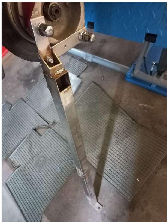
Um die Nabenmutter (SW 36, mit 250 Nm angezogen!) lösen zu können, benötigt man das Werkzeug „Rou 604“, welches ich mir selbst angefertigt habe.
