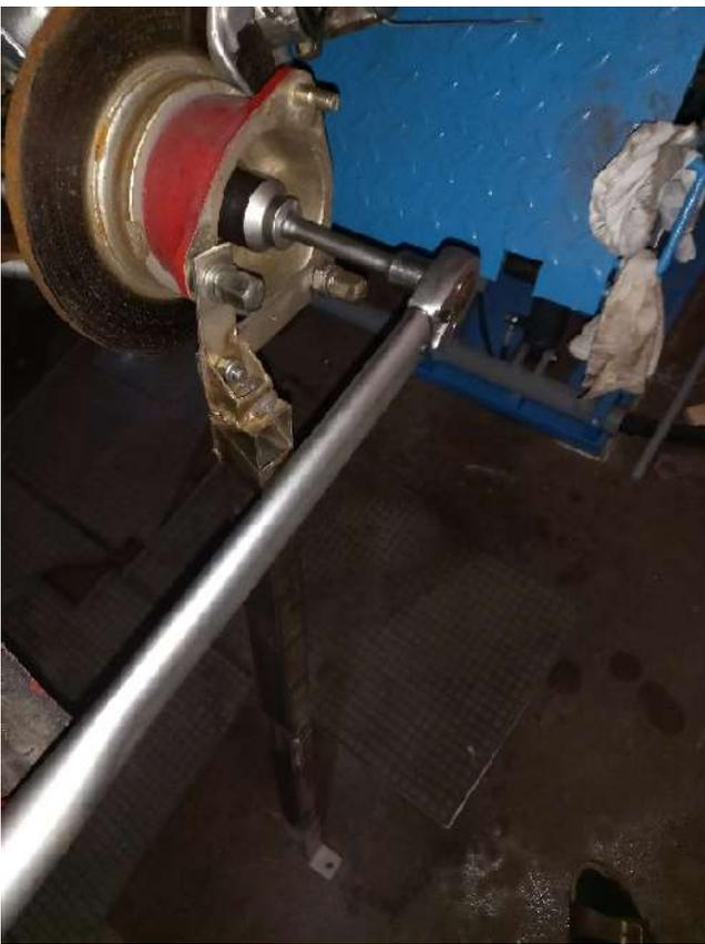
Entgegen der Anleitung im Reparaturhandbuch habe ich eine andere Methode verwendet. Man löst die vier Inbusschrauben am unteren Querlenker.
