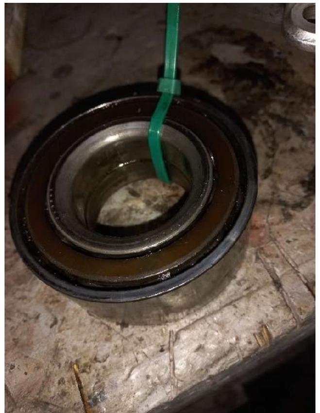
Das ausgebaute, zweireihige Schrägrollenlager.
