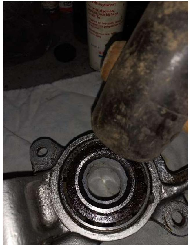
Dann kann schon die Radlagereinheit mit der Kunststoff-Fixierhülse eingetrieben werden, dafür ist ein Gummihammer ausreichend.
