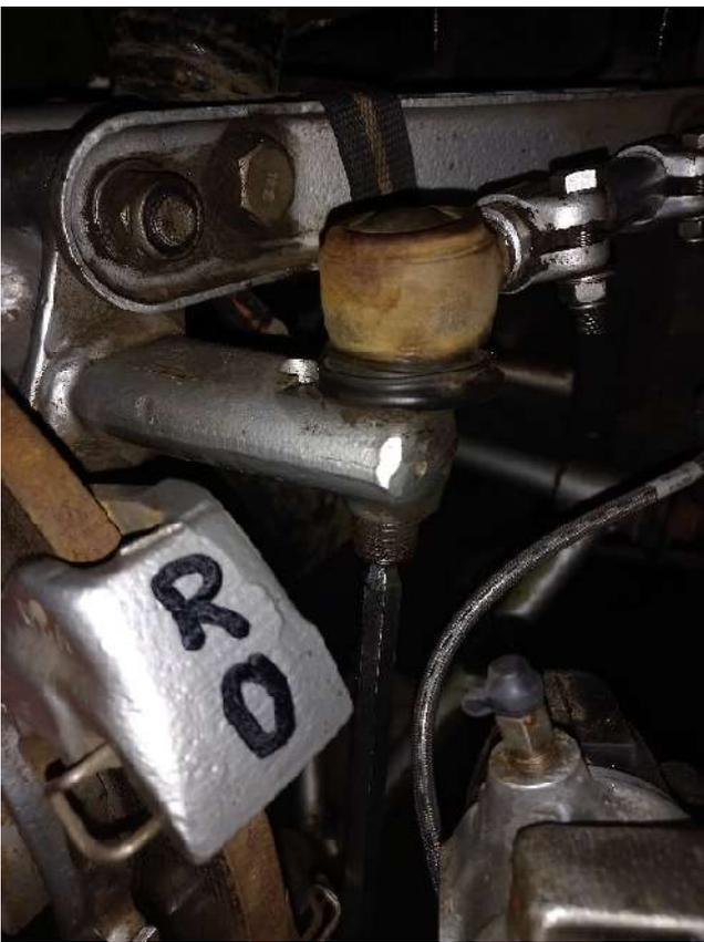
Dann wird das Kugelgelenk mittel Inbusschlüssel (andere Ausführung mit Sechskant-Nuss) nach oben herausgeschraubt.
