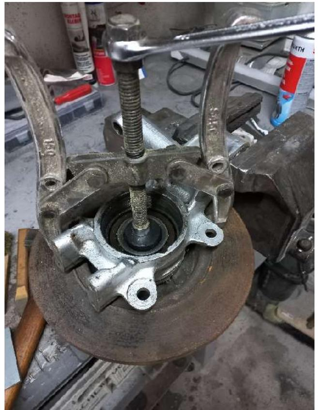
Als nächstes muss der Zapfen für die Aufnahme der Antriebswelle nebst Bremsscheibe herausgepresst werden, dies ging bei mir recht gut mittels Abzieher und passender Scheibe. Das Lager hat innen einen Durchmesser von 42 mm, passende Scheibe ist also z.
