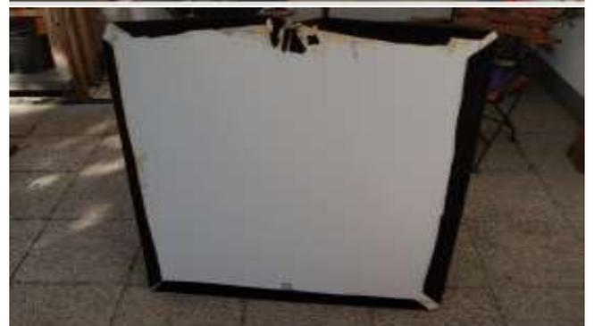
Ist die Platte auf Endmaß zugeschnitten, kann sie an den Kanten etwas geschliffen, entstaubt, entfettet und dann mit dem Bezugsstoff beklebt werden. Ich habe hierfür wieder Teppichkleber verwendet.
