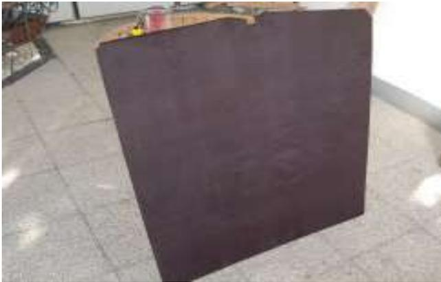
Nachdem der Kleber getrocknet ist, kann das gute Stück in einem Teil reinzirkuliert werden, das ist etwas fummelig, klappt aber durchaus. Allein hängt der neue Dachhimmel in der Mitte herunter, weil das Ganze auf Spannung montiert wurde. Mittels der Spannstützen drückt man dann in der Mitte den Himmel hoch, bis er umschlägt gen Dachhaut et voilà, er passt und sitzt perfekt.
